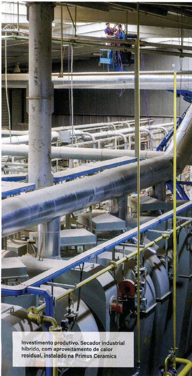
Investimento produtivo. Secador industrial híbrido, com aproveitamento de calor residual, instalado na Primus Ceramics
