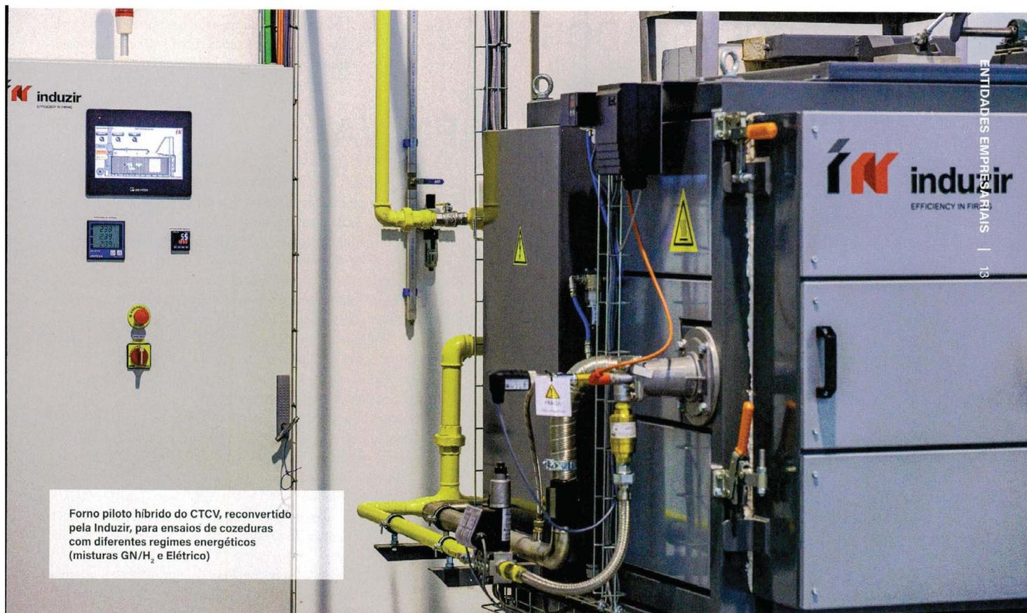
Forno piloto híbrido do CTCV, reconvertido pela Induzir, para ensaios de cozeduras com diferentes regimes energéticos (misturas GN/H<sub>2</sub> e Elétrico)
